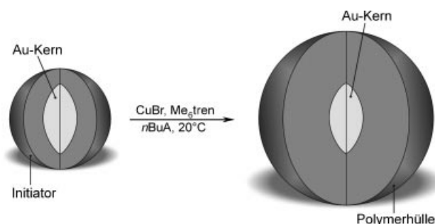
Abbildung 1. Erzeugung der Polymerhülle auf den Au-NPs; n BuA = n -Butylacrylat.
